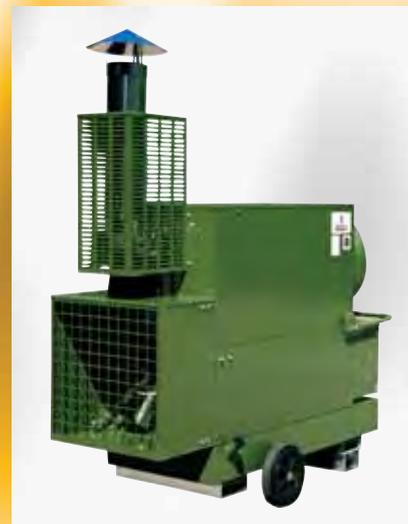
Generadores de aire caliente de difusión directa del aire o por medio de tubos flexibles, con quemador de gasóleo y depósito incorporado, intercambiador de calor enteramente en acero inox AISI 430 de diseño exclusivo, ventiladores helicoidales o centrífugos, de altas prestaciones, equipamiento eléctrico de mando, control y seguridad, envolvente externo en chapa de zinc pintada, con aislamiento térmico anti- calor.
