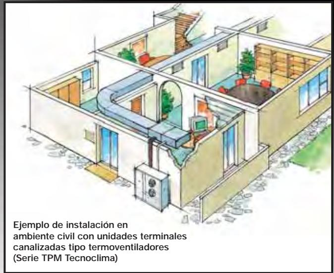
Ejemplo de instalación en ambiente civil con unidades terminales canalizadas tipo termoventiladores (Serie TPM Tecnoclima)
